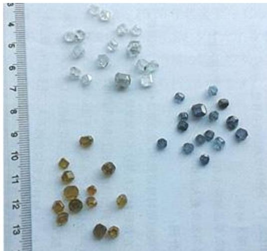
그림 11. 中烏新材(Ukraine new material)의 Ib, IIa, IIb형 다이아몬드 단결정
