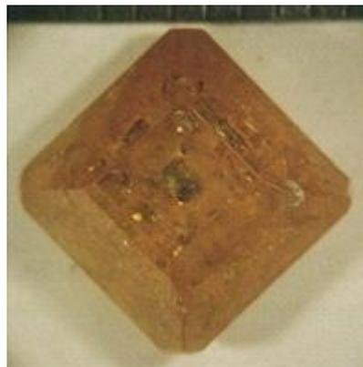
그림 4. 10mm, 2.45ct 의 타입 Ib 단결정
