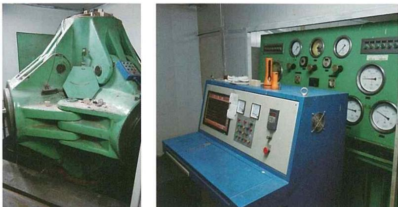
Fig.8 가동 중인 큐빅형 멀티·앤빌 장치(좌) 와 조작시스템 (우)
