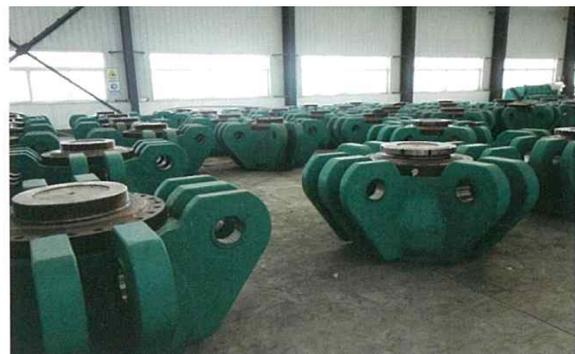
Fig.14 제조 중인 큐빅형 멀티-앤빌 장치
